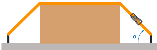
Influence de l'angle d'arrimage sur la force de tension (STF).
