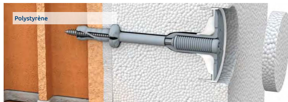
R-KWX-63 Plaque de maintien d'isolation avec perforateur ø 63mm
