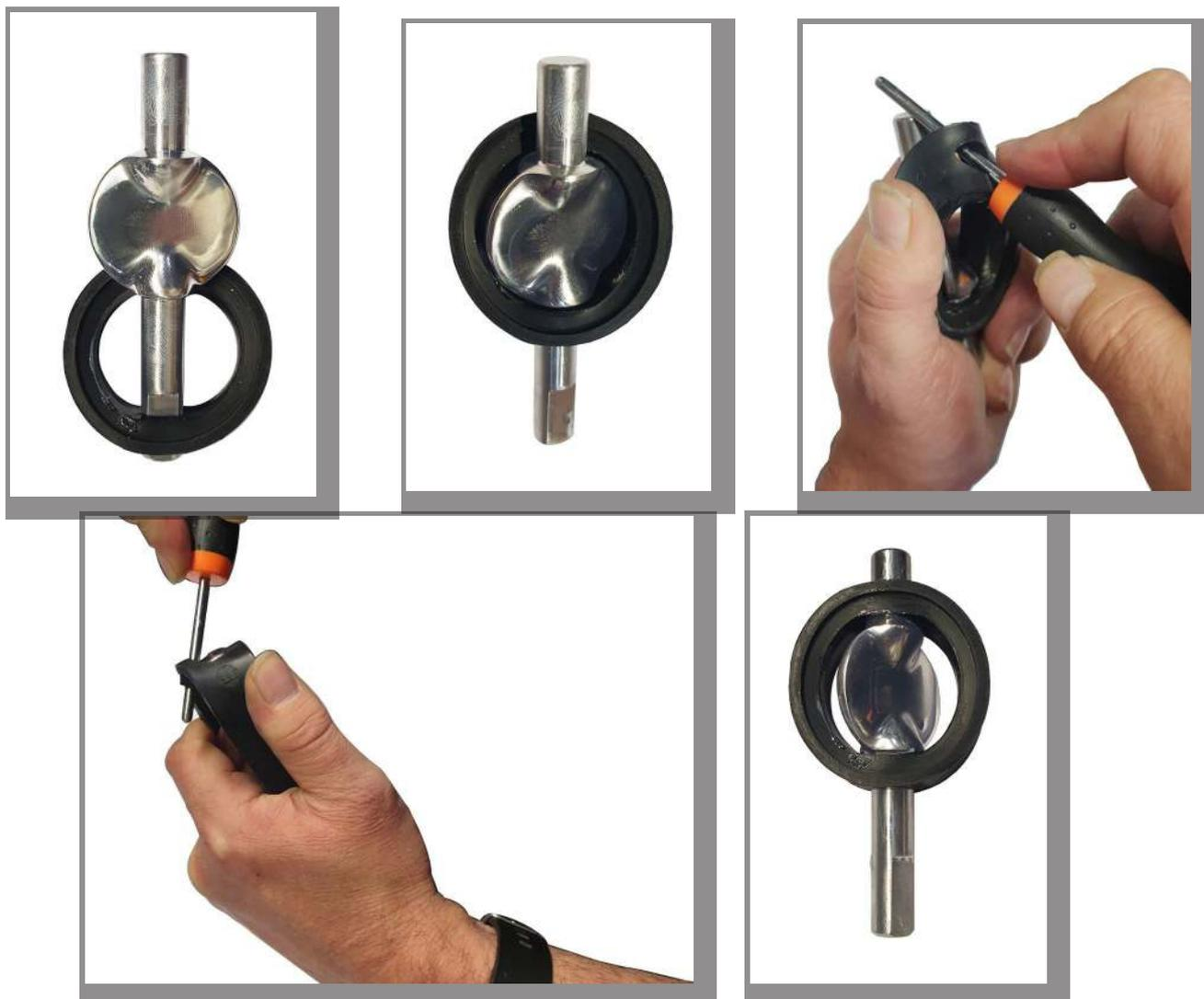
A partir du DN60, le joint est suffisamment grand pour être monté sans outil (déformation possible à la main).
